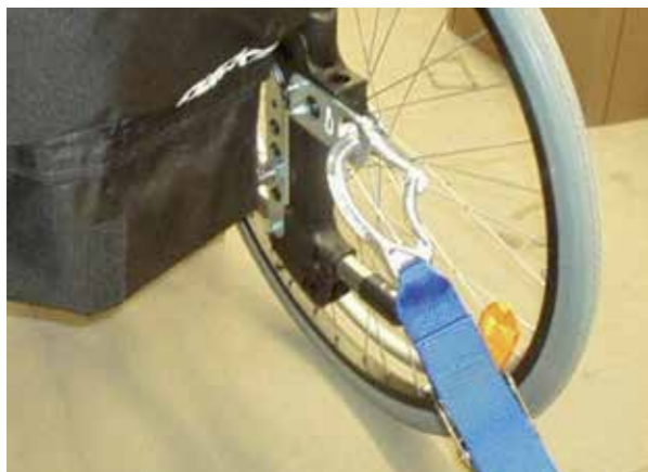
Punto di ancoraggio posteriore della carrozzina
