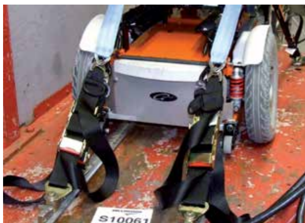
Punto di ancoraggio posteriore della carrozzina
