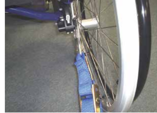
Punto di ancoraggio posteriore della carrozzina
