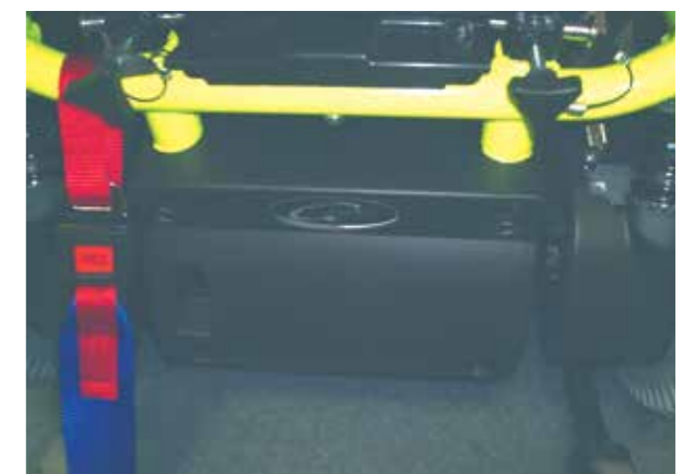
Punto di ancoraggio anteriore della carrozzina
