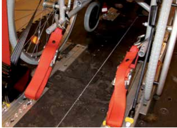
Punto di ancoraggio posteriore della carrozzina
