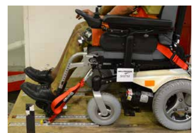
Punto di ancoraggio anteriore della carrozzina
