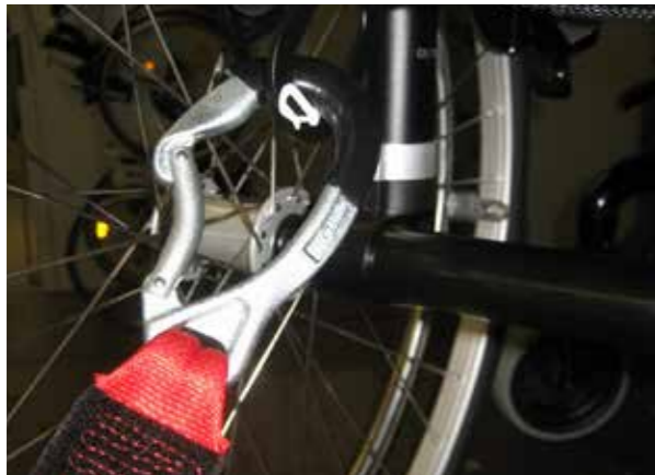
Punto di ancoraggio posteriore della carrozzina
