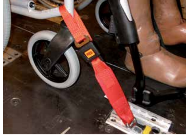
Punto di ancoraggio anteriore della carrozzina
