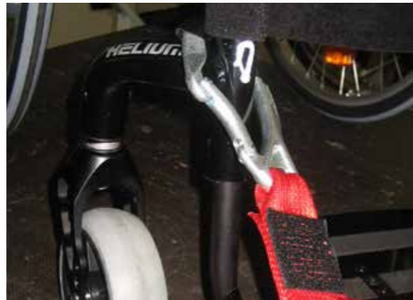
Punto di ancoraggio anteriore della carrozzina
