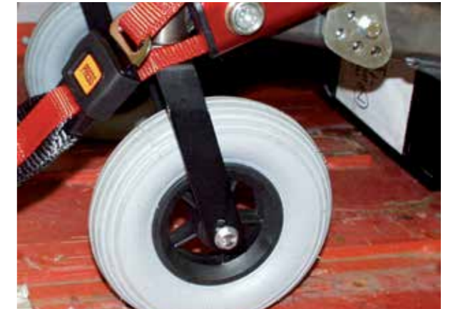
Punto di ancoraggio anteriore della carrozzina
