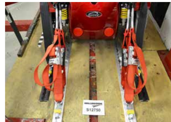
Punto di ancoraggio posteriore della carrozzina Attenzione: due cinghie per lato!
