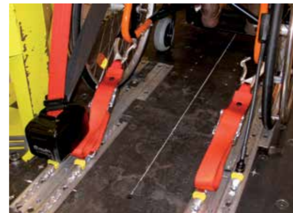
Punto di ancoraggio posteriore della carrozzina
