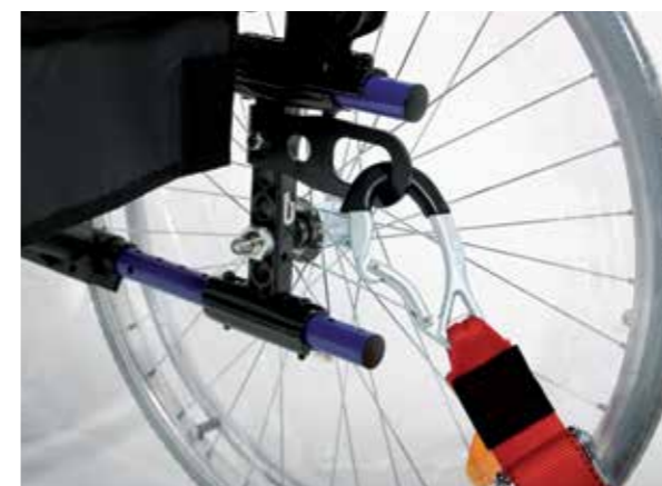
Punto di ancoraggio posteriore della carrozzina
