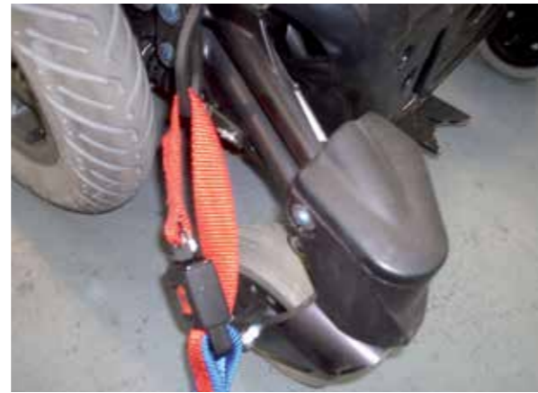
Punto di ancoraggio anteriore della carrozzina
