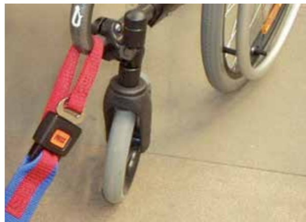
Punto di ancoraggio anteriore della carrozzina
