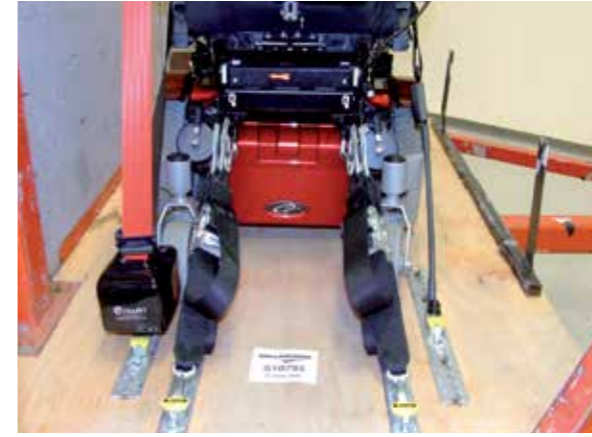
Punto di ancoraggio posteriore della carrozzina Attenzione: due cinghie per lato!
