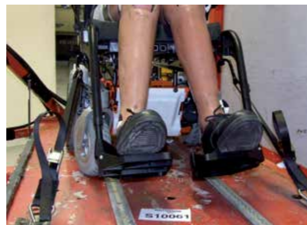
Punto di ancoraggio anteriore della carrozzina
