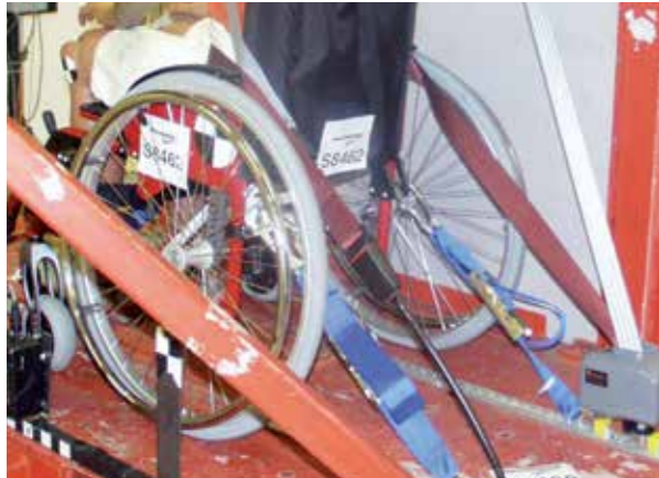
Punto di ancoraggio posteriore della carrozzina
