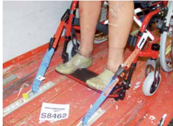
Punto di ancoraggio anteriore della carrozzina
