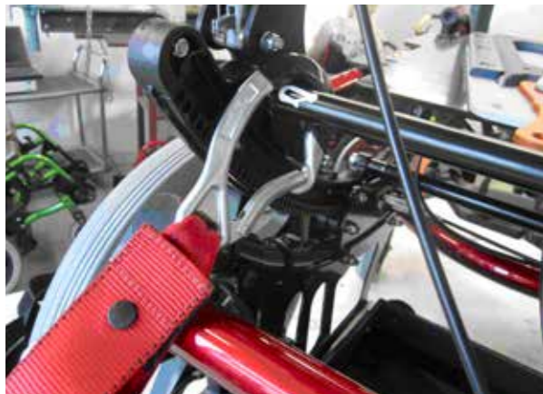
Punto di ancoraggio posteriore della carrozzina
