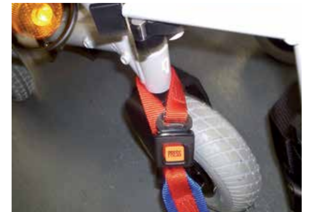
Punto di ancoraggio anteriore della carrozzina
