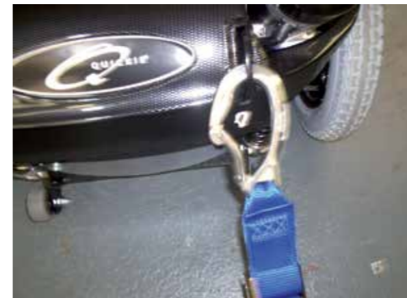
Punto di ancoraggio posteriore della carrozzina
