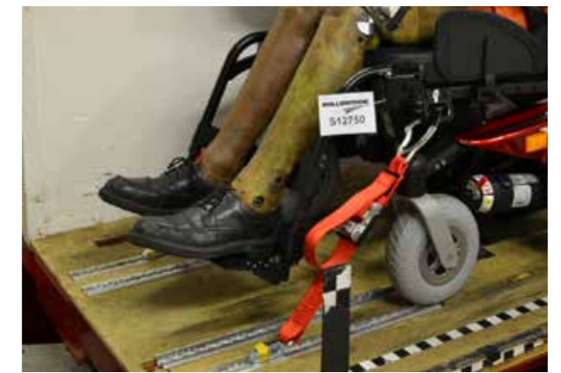
Punto di ancoraggio anteriore della carrozzina
