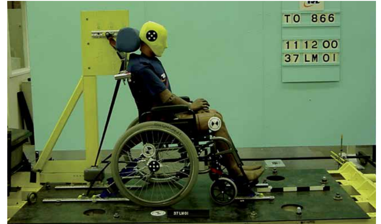
Carrozzina ancorata ai binari, prima dell'impatto
