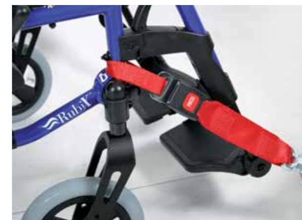
Punto di ancoraggio anteriore della carrozzina
