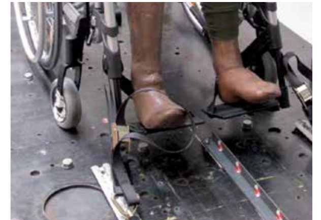
Punto di ancoraggio anteriore della carrozzina
