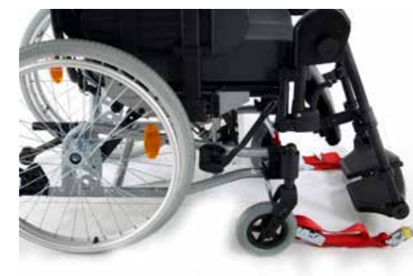
Punto di ancoraggio anteriore della carrozzina
