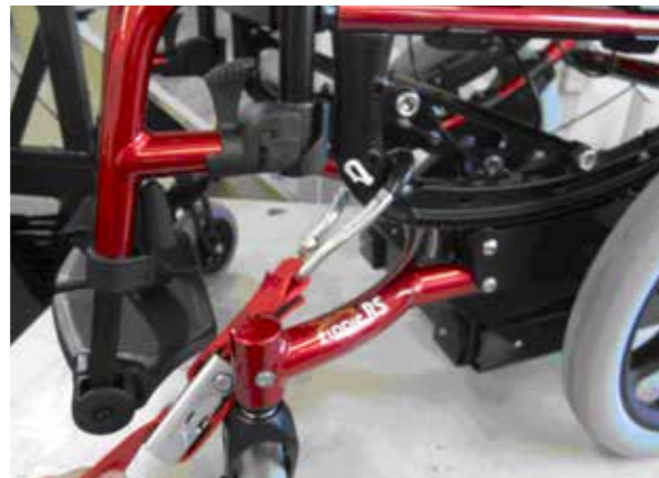
Punto di ancoraggio anteriore della carrozzina
