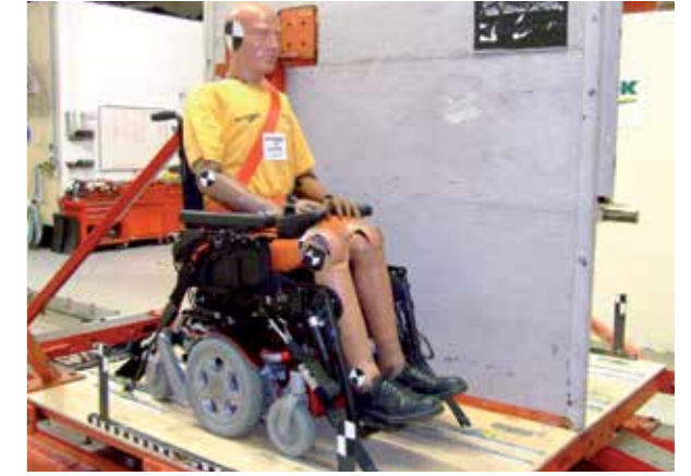
Punto di ancoraggio anteriore della carrozzina
