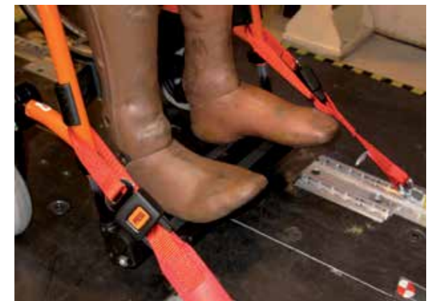
Punto di ancoraggio anteriore della carrozzina
