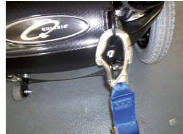
Punto di ancoraggio posteriore della carrozzina
