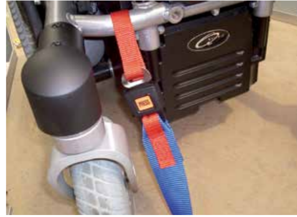
Punto di ancoraggio anteriore della carrozzina
