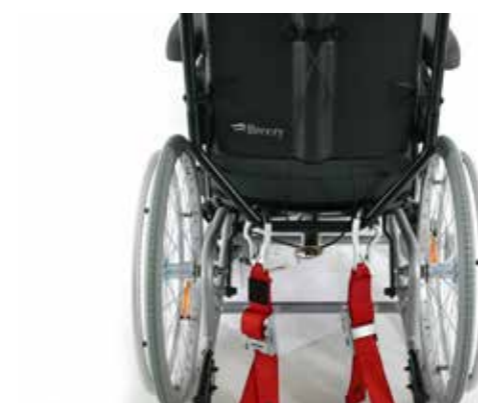
Punto di ancoraggio posteriore della carrozzina
