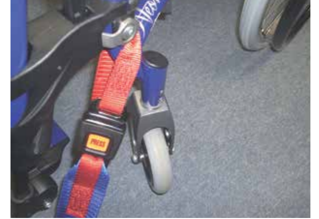
Punto di ancoraggio anteriore della carrozzina
