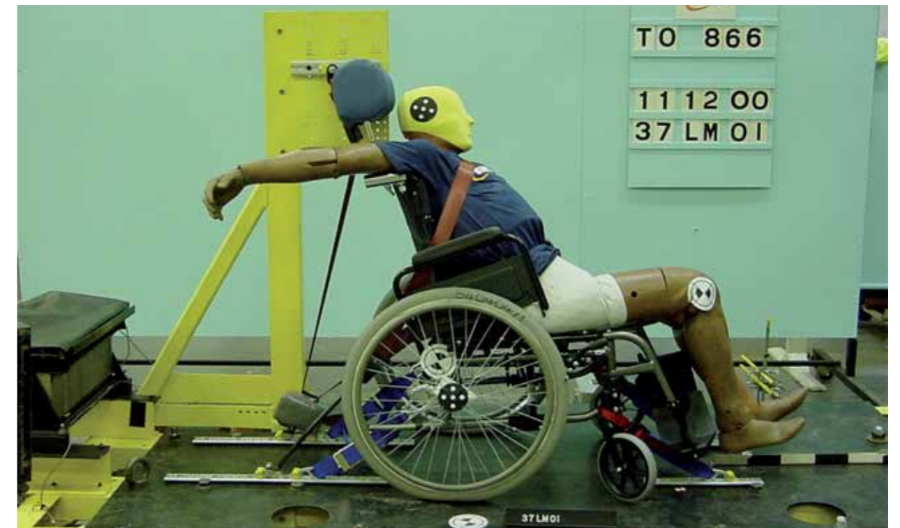
Carrozzina ancorata ai binari, dopo l'impatto
