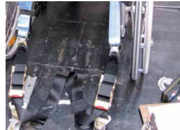
Punto di ancoraggio posteriore della carrozzina
